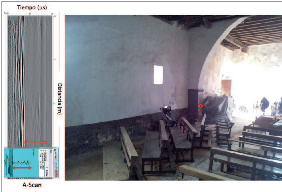
Figura 6. Radargramas en arco de diafragma y fotografía de la zona.
